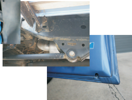
pas de rouille à la porte feuillure (normalement il y a toujours la rouille!)
