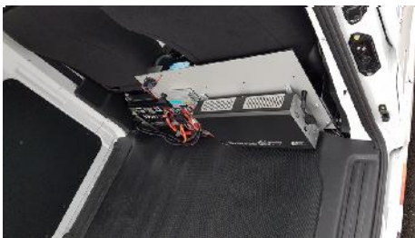
Inverter und Lilon Batterie
