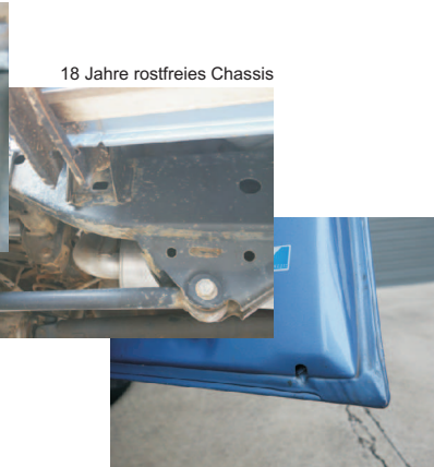
kein Rost bei Türfalz (rostet immer!)
